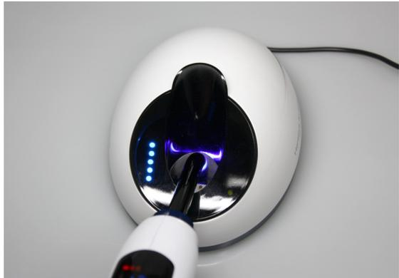
Geben Sie das Ende des Lichtleiters in die Mitte der ovalen Anzeige und belichten Sie diese. Sie können den optischen Ausgang sofort sehen und überprüfen. Bitte beachten Sie, dass ein unbeabsichtigter Fehler auftreten kann abhängig von der Lage und dem Winkel des Lichtleiters.
