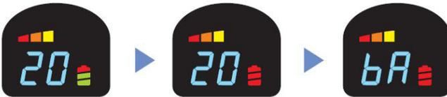
1. Wenn die Batteriestandanzeige komplett grün ist, ist die Batterie voll geladen. Wenn sie komplett auf rot wechselt wird die Zeit bis zum nächsten Laden angezeigt.
