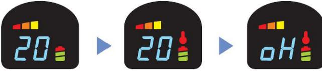
1. Wenn die Temperatur der Pekalux Power LED über die eingestellte Temperatur steigt, leuchtet die Überhitzungswarnanzeige auf.
